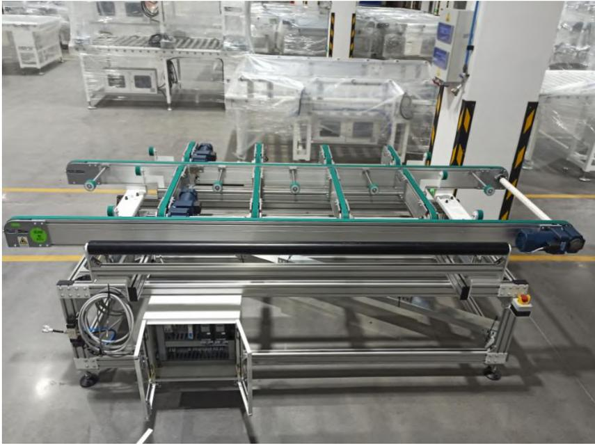
图 2.2 C52 站换向输送线产品照片
